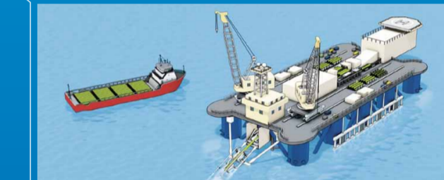
Transportschiffe versorgen die Verlegeschiffe laufend mit Rohren, damit rund um die Uhr gebaut werden kann.
