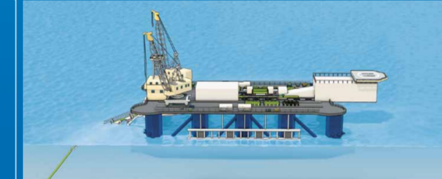
An Bord des Verlegeschiffes werden die Rohre zusammengeschweißt und die Pipeline auf den Meeresboden abgesenkt.
